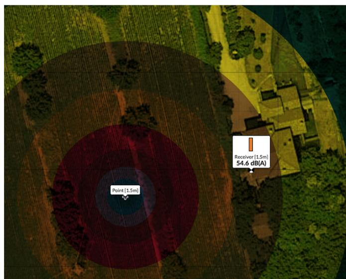
Allo scopo di determinare il livello assoluto di immissione, si effettua una somma logaritmica tra il clima acustico misurato nella posizione R16 (n. 5) ed il contributo in termini di emissione dovuto alle sorgenti di progetto.
